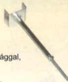
Gerincléctartó állítható magassággal, beütőcsavarral, 30 mm Szár: 75, beütő 250 mm. Szükséglet: 1 db / 0,7 fm gerinc
